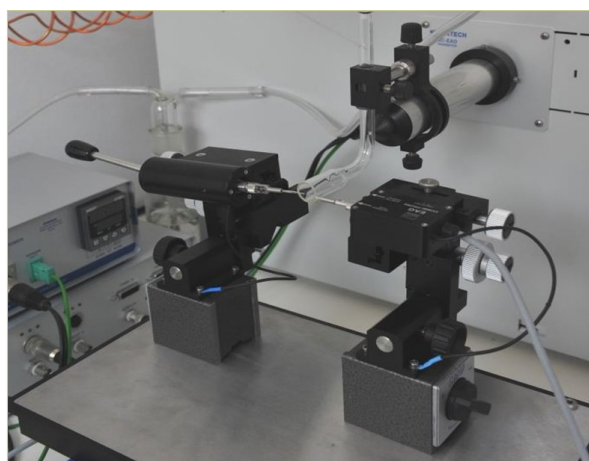
Εικόνα 1. Τμήμα του συστήματος αέριας χρωματογραφίας-ηλεκτροαντενογραφίας (GC-EAD)
