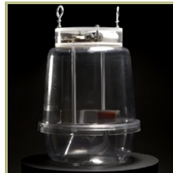
Εικ. 2. Παγίδα τύπου McPhail με ηλεκτρονικό μηχανισμό για την αυτόματη καταγραφή των συλλήψεων
